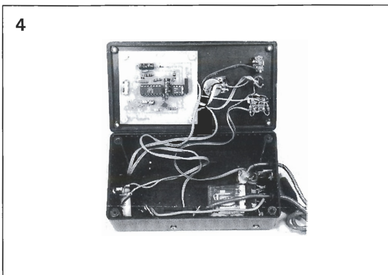
Figura 4. Todos los componentes, excepto el relé y el fusible, están montados en la placa de circuito impreso.
